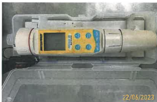
ภาพที่ 55 อุปกรณ์ตรวจวัดความเค็ม (Salinity Meter) สำหรับตรวจวัดคุณภาพน้ำทิ้งบริเวณ Inspection Pit
