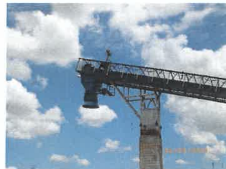
ภาพที่ 3 ท่อ Chute ปลายสายพานลำเลียง
